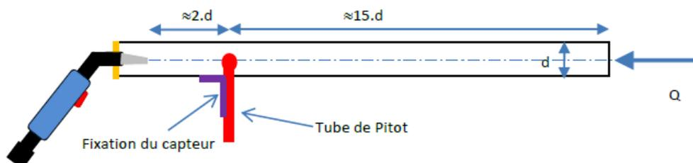
Le tableau suivant donne les dimensions des tubes et sondes de mesure utilisables pour mesurer les débits utiles pour les torches MIG-MAG et pour les torches TIG :
