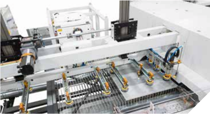
Chargement et déchargement automatique avec chariot frontal.
