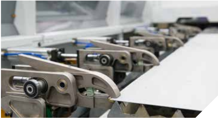
L'ensemble est équipé de 4 pinces rétractables pour éviter que la tôle ne glisse lors des mouvements.
