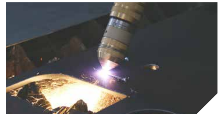
Coupe chanfrein d'une tôle avec une découpe plasma.
