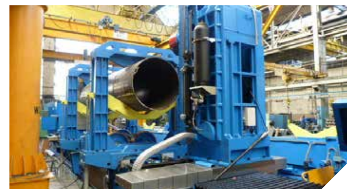
La machine est utilisée pour le meulage des soudures internes et externes sur les extrémités des tuyaux utilisés pour le transport de gaz et de pétrole.
