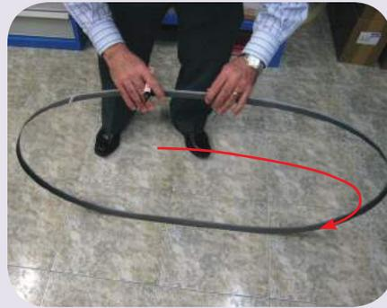
2. On fait tourner la scie jusqu'à trouver de nouveau la soudure.
