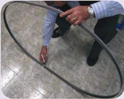
1. Nous mettons la soudure de la scie contre le sol en faisant une marque avec un marqueur.
