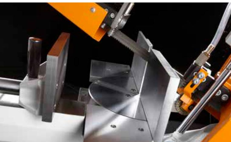
Matière serrée par un étau horizontal à faible course, à commande hydraulique.
