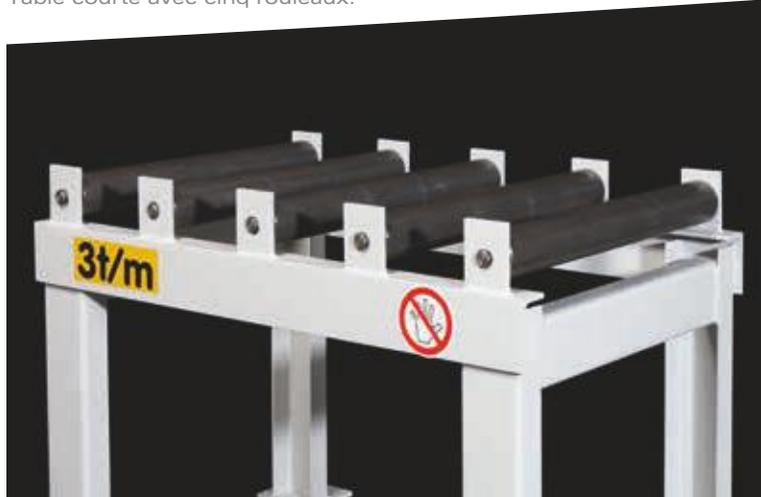
Table à rouleaux charge utile de 2 t avec récupération du liquide d'arrosage (option).
