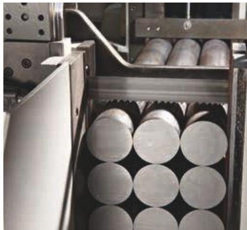
Dispositif hydraulique de serrage intégral pour coupes en paquet, côté amont.
