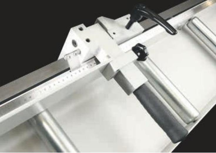
Butée de mesure manuelle KASTOexact M 150.
