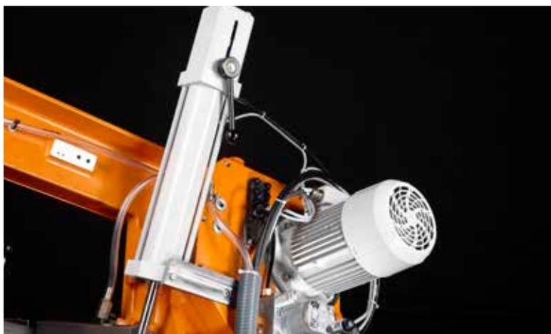
Brosse chasse-copeaux synchronisée avec la vitesse de défilement du ruban.
