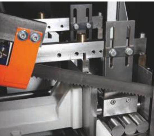
Dispositif hydraulique de serrage intégral pour coupes en paquet, côté aval.
