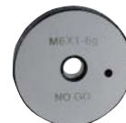
C : bague filetée n'entre pas
