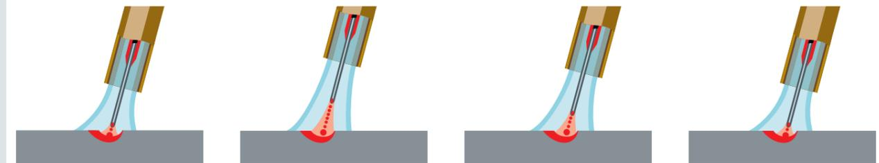
La modification de la distance de la torche permet au soudeur de réagir plus aisément aux conditions ambiantes et changeantes.
