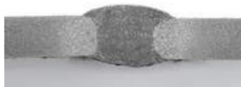
Soudure optimale, avec légère surépaisseur, sans insuffisance de fusion : pour une tolérance de fente et un recouvrement de fente maximaux.
