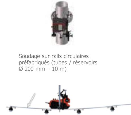
Soudage sur rails circulaires préfabriqués (tubes / réservoirs Ø 200 mm - 10 m)
