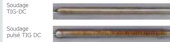
Pas d'inclusions de tungstène grâce à l'amorçage HF
