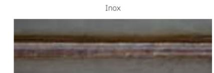
**La solution intelligente de Lorch :** L'arc de MicorMIG Pulse transmet moins d'énergie à la pièce à souder et évite donc les colorations thermiques indésirables. Les retouches représentant une grande dépense de temps et d'argent, nécessaires par exemple pour éliminer les colorations thermiques, sont réduites avec l'arc MicorMIG Pulse. Et ce, avec une saisie de racine exacte.
